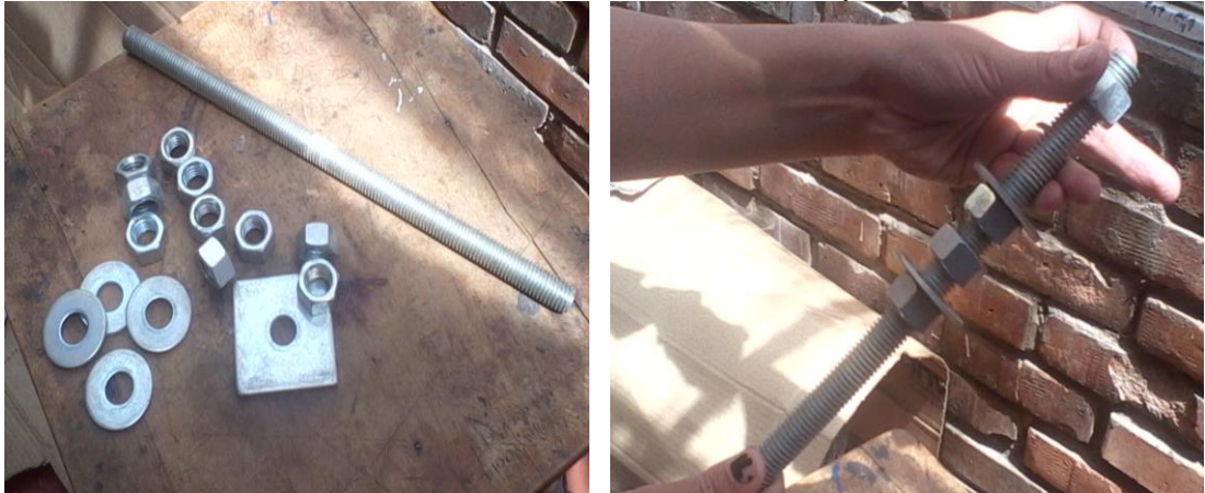
Foto 2-17 Construcción de la raíz del anclaje
