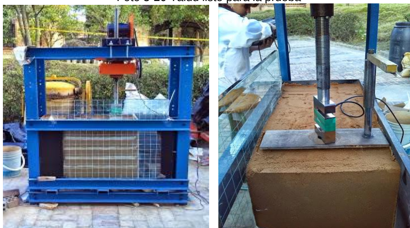
Foto 3-20 Talud listo para la prueba
