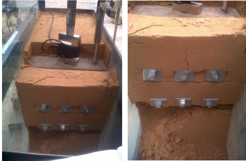
Foto 4-4 Falla presentada por el talud
