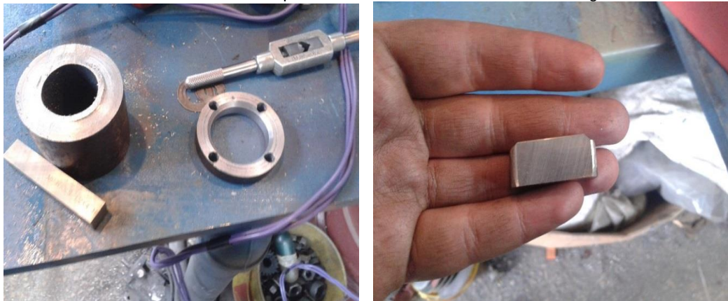
Foto 2-9 sistema de cuña para transformación de la rotación en carga axila
