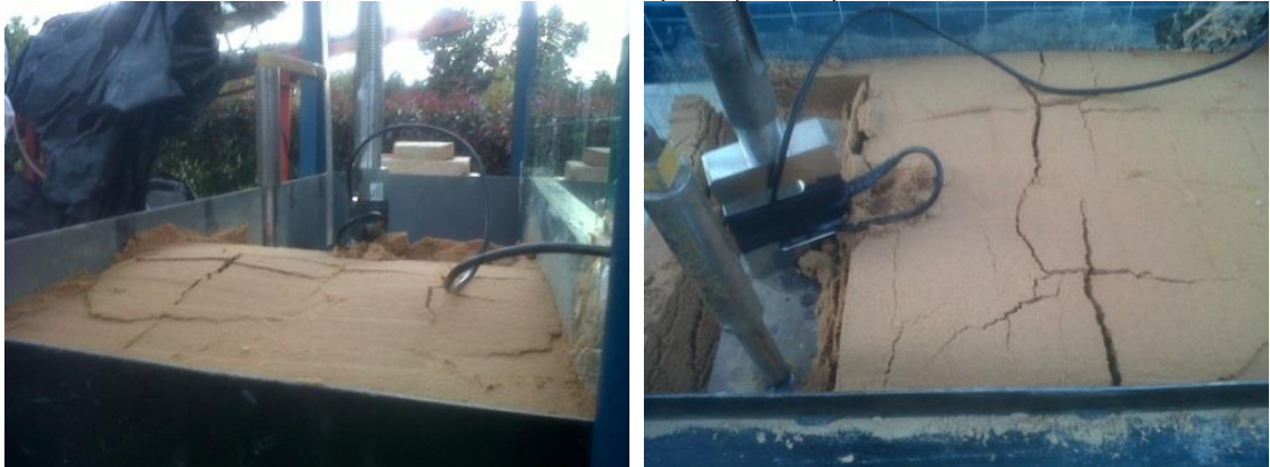
Foto 4-10 falla del talud por la parte superior
