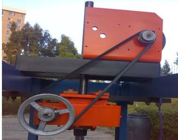
Foto 2-11 Sistema de transmisión mediante el uso de Polea y correa
