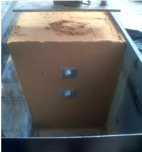
Foto 3-23 Talud reforzado con 2 anclajes
