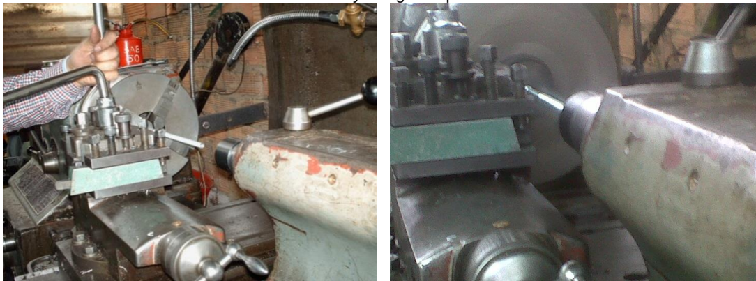
Foto 2-14 Mecanizado y arreglo de probetas de acero
