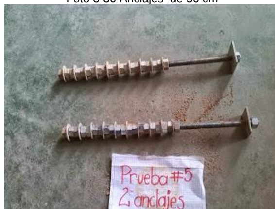
Foto 3-30 Anclajes de 50 cm
