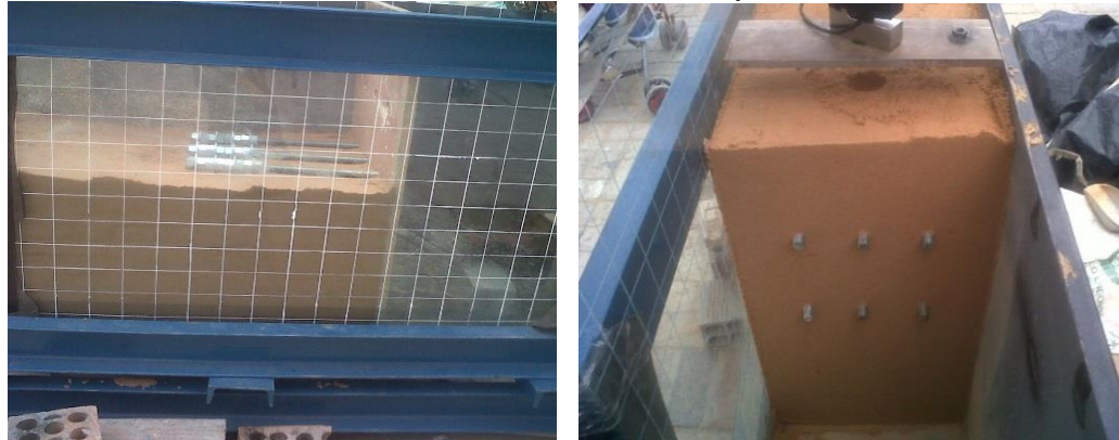
Foto 3-28 Ubicación de los anclajes
