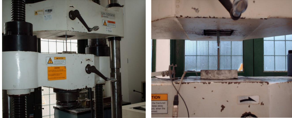
Foto 3-7 . Prueba de tracción maquina universal
