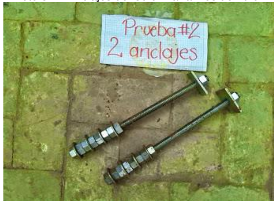
Foto 3-21 Anclajes de 30 cm la raíz es de 10 cm
