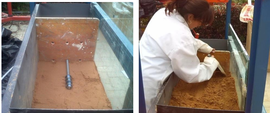
Foto 3-18 Ubicación de los anclajes en el talud
