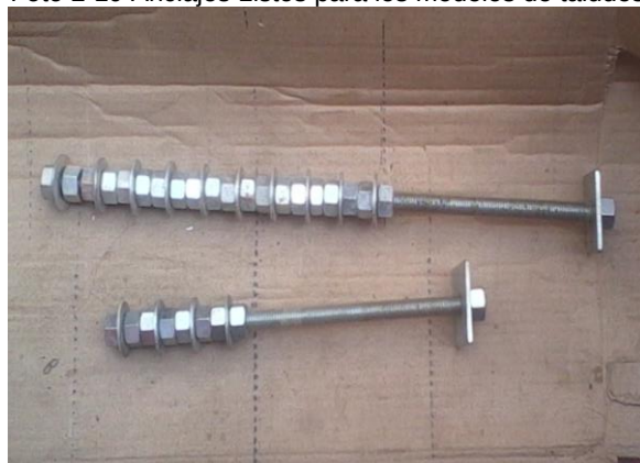
Foto 2-19 Anclajes Listos para los modelos de taludes
