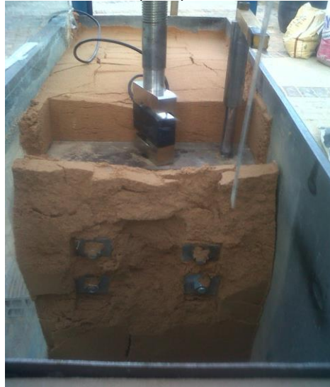
Foto 4-8 Vista principal Falla del talud
