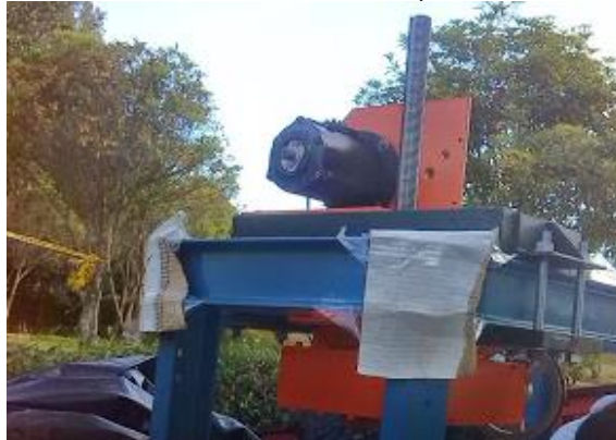
Foto 2-13 Motor eléctrico. Permite el desplazamiento del tornillo
