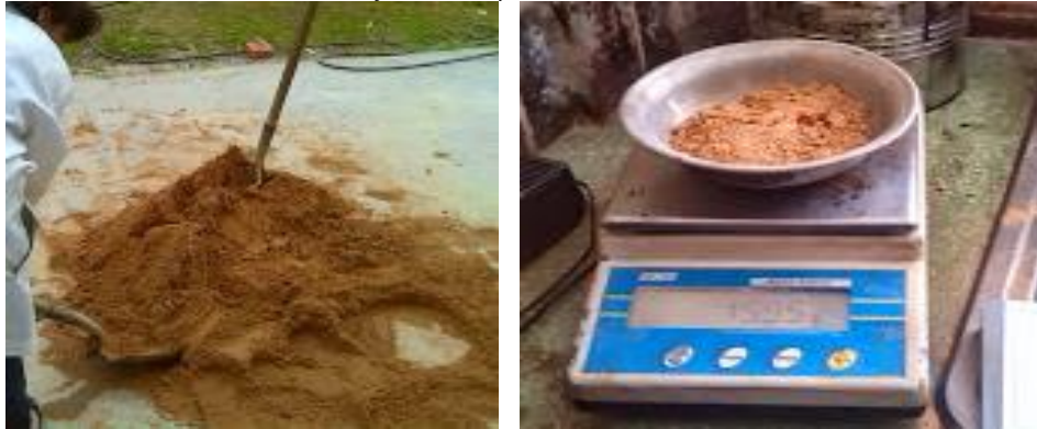
Foto 3-11 Mezcla y muestra para humedad del suelo arenoso
