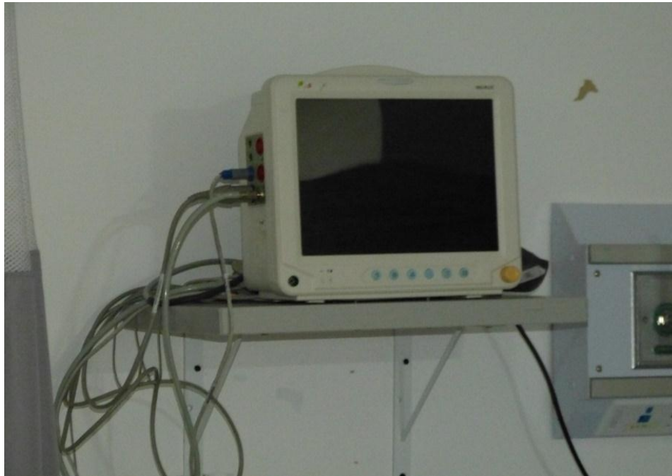
Figura 55. Monitor multiparamedico sin anclaje.
