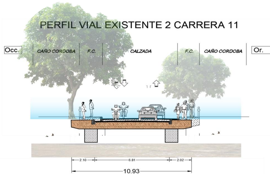
Figura 25. Perfil vial carrera 11
