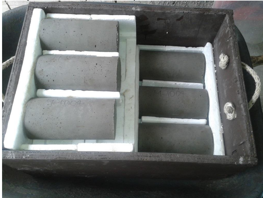
Fotografía 45. Cajón de madera para el transporte de los cilindros de concreto
