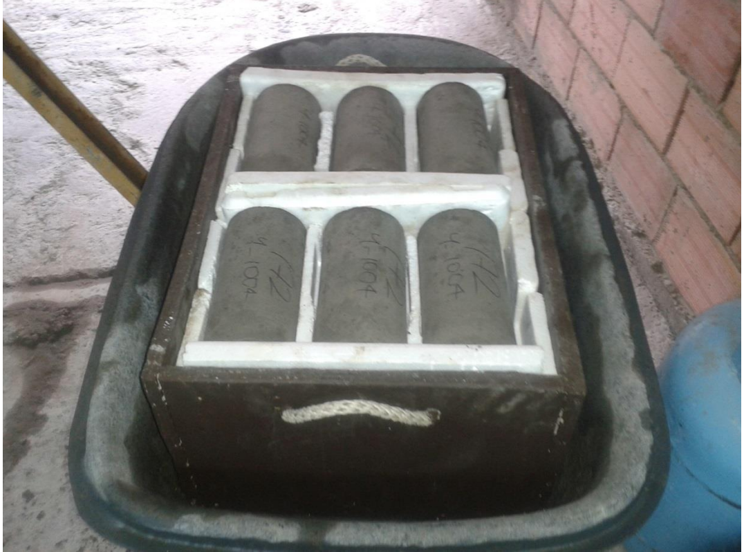
Fotografía 46. Transporte de cilindros de concreto
