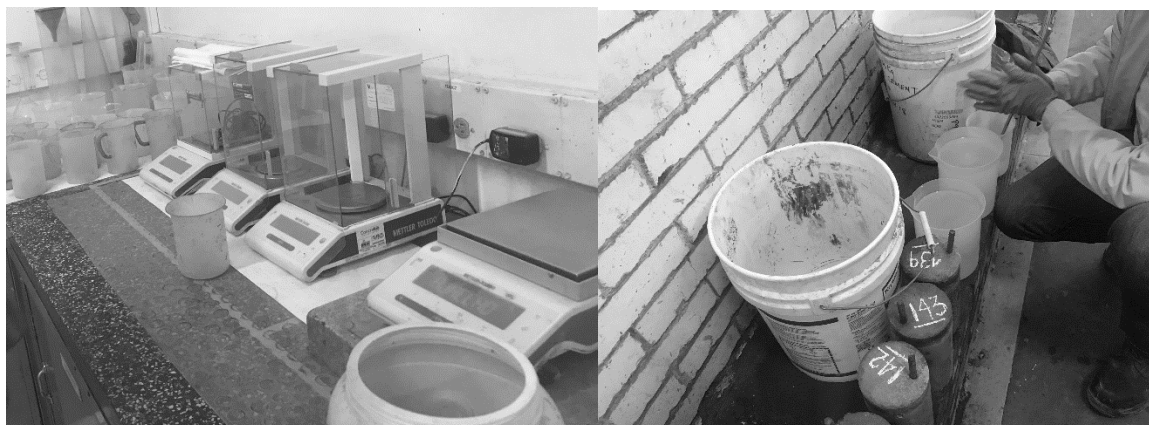
Figura 27. Preparación de probetas en solución
