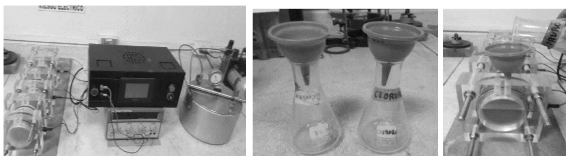
Figura 24. Adición de solución de hidróxido de sodio y cloruro de sodio.
