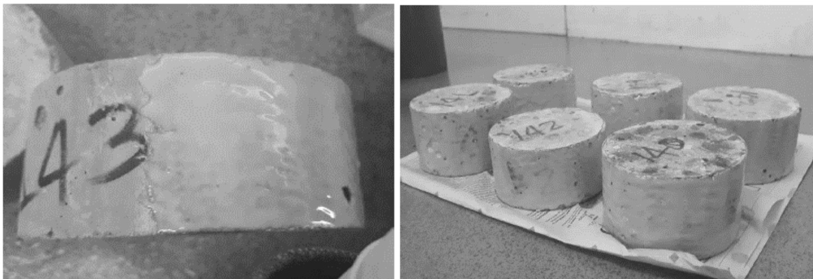
Figura 22. Impermeabilización de cilindros.
