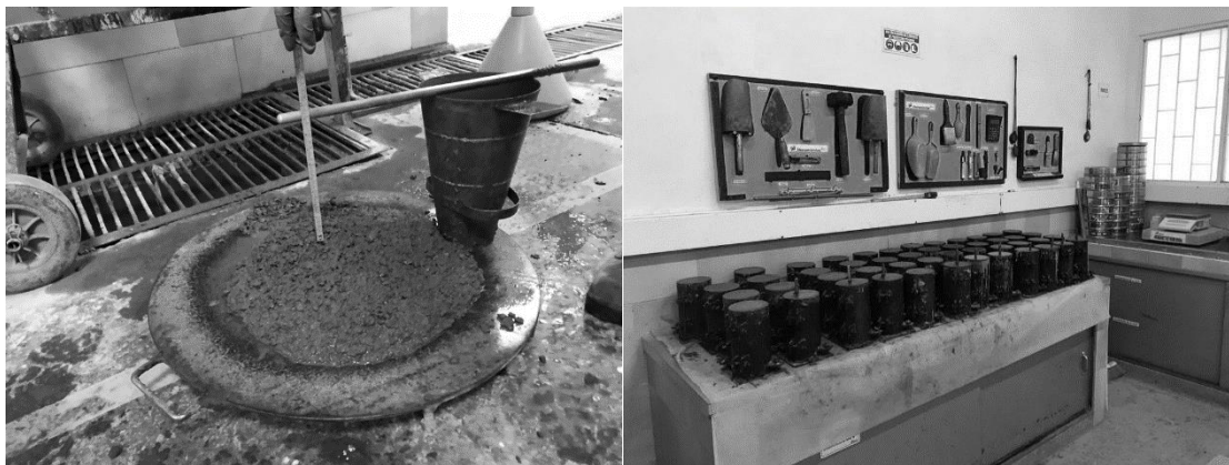
Figura 19. (a) Toma de asentamiento y (b) elaboración de especímenes de concreto
