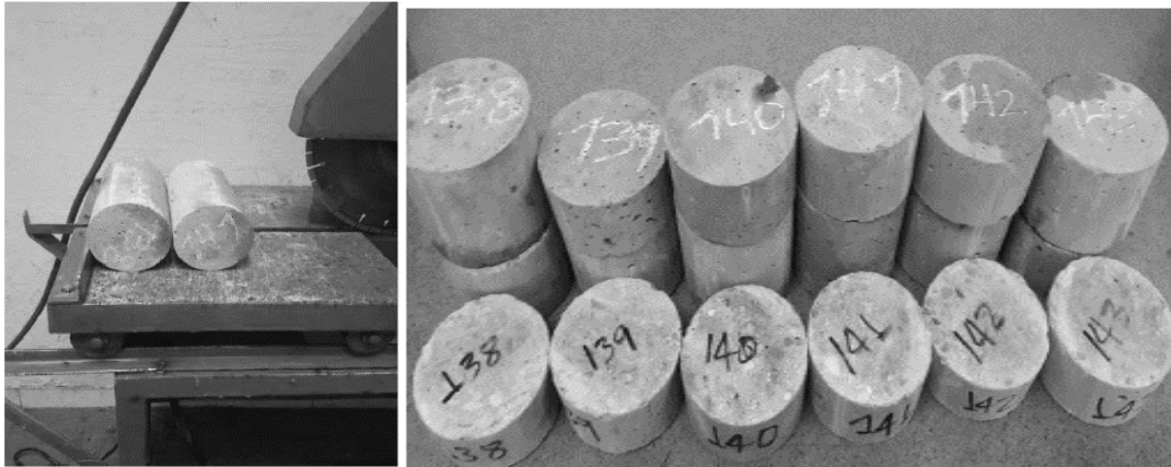
Figura 21. Corte y aserrado de las probetas
