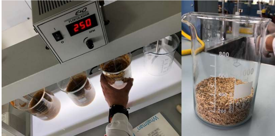
Figura 6. Biomasa en vaso, tiempo de retención y tratamiento a 250 rpm por Gustavo Murcia, 2020.
