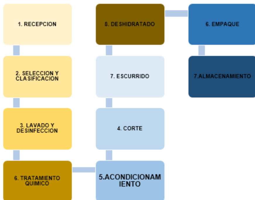
Figura 2. . Proceso de deshidratación de piña. Adaptado de Nicolas Vasquez Peña, 2017
