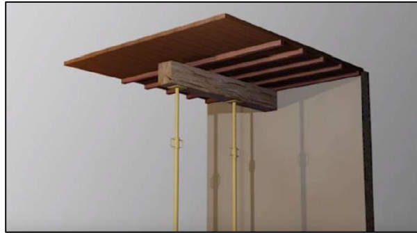
Ilustración 61 Apuntalamiento o retranque previo a la intervención
