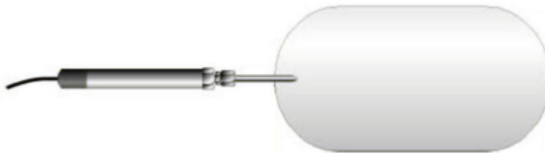
Figura 86 Celda de presión total (fuente: Guía técnica de instrumentación y auscultación en el proyecto y construcción de túneles urbanos, grupo de trabajo 11-20 AETOS)
