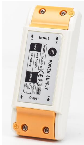
Figura 42. Fuente de voltaje fijo 12VDC/3A.
