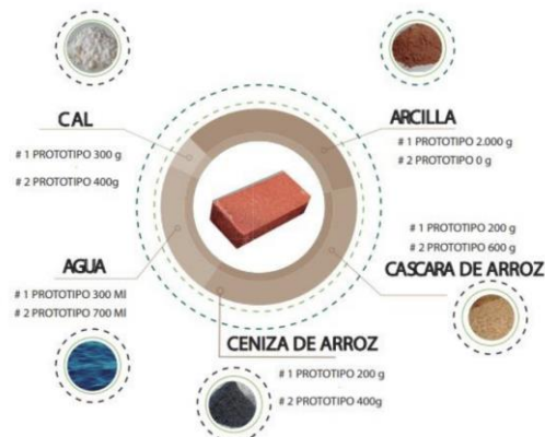
Figura 95. Gráfico materiales y porcentaje para mezcla del adobe.
