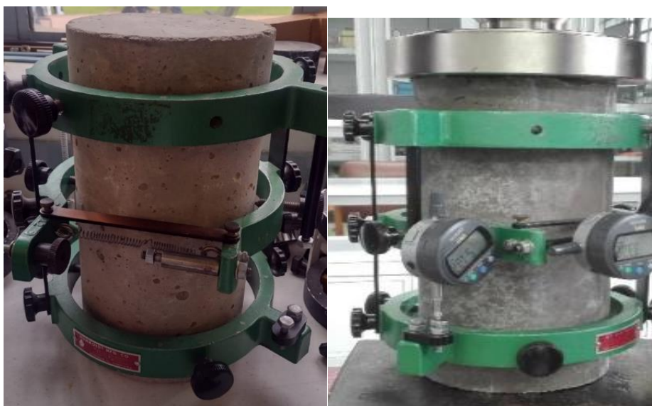
Figura 20. Ensayo de módulo de elasticidad del concreto
