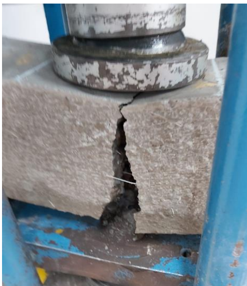
Figura 18. Ensayo de módulo de rotura (MR) en viguetas de concreto
