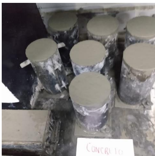
Figura 11. Fabricación de cilindros de concreto
