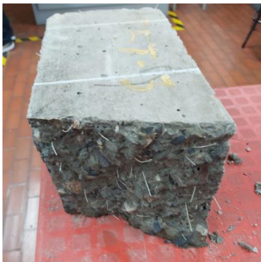
Figura 19. Falla de viguetas de concreto a flexión
