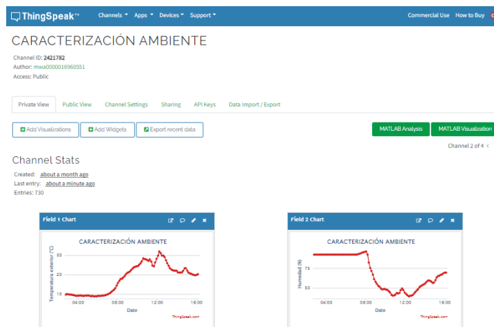
Ilustración 38. Canal de caracterización ambiente, donde se observa el Field de temperatura exterior y humedad.
