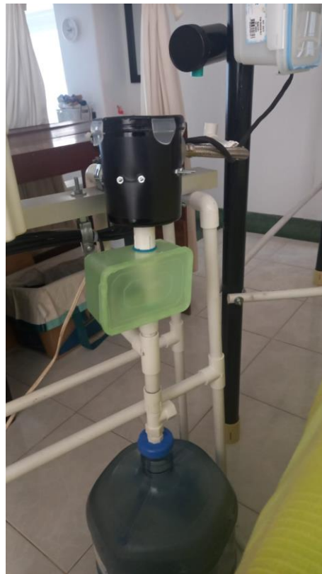
Ilustración 32. Estructura para el sistema de almacenamiento de agua y obtención de datos para calidad de agua.
