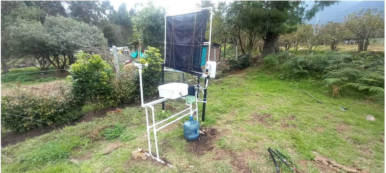
Ilustración 43. Evidencia de puesta en marcha del sistema atrapanieblas tridimensional, vista frontal.
