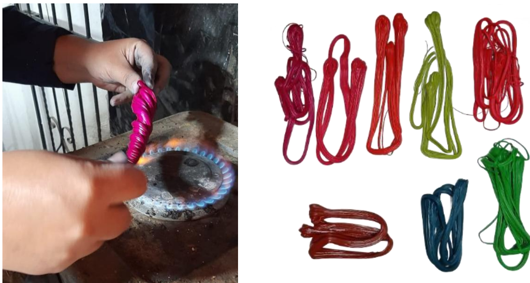
Figura 12. Fijación del color quemando la resina y Resina teñida en diferentes colores
