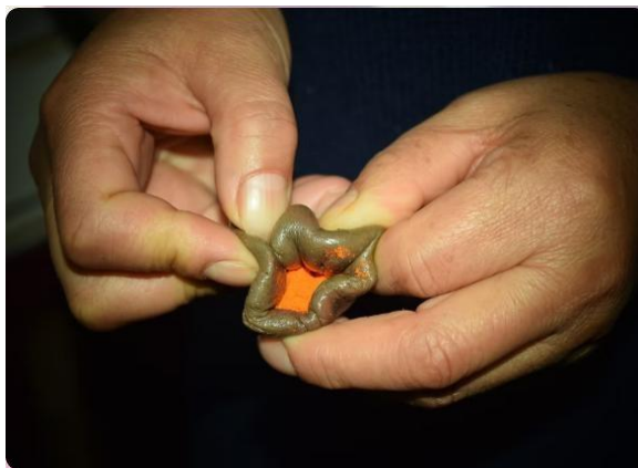
Figura 11. Aplicación de color a la resina con pigmentos naturales o industriales
