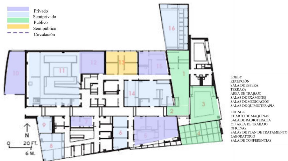
Figura 12. Planta Arquitectónica UW Cáncer Center
