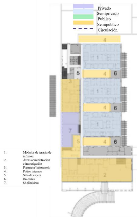
Figura 15. Planta arquitectónica segundo piso
