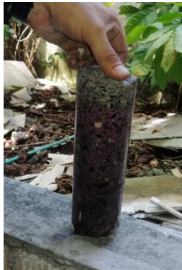
Figura 17 Ensayo de carbonatación en núcleo extraído
