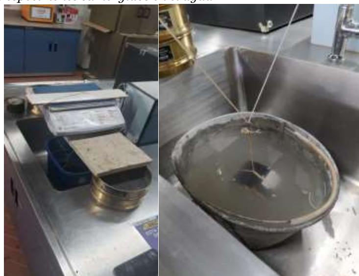
Figura 13. Peso de los especímenes sumergidos en el agua
