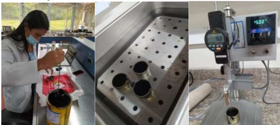
Figura 8. Penetración y Baño maría a 25°C
