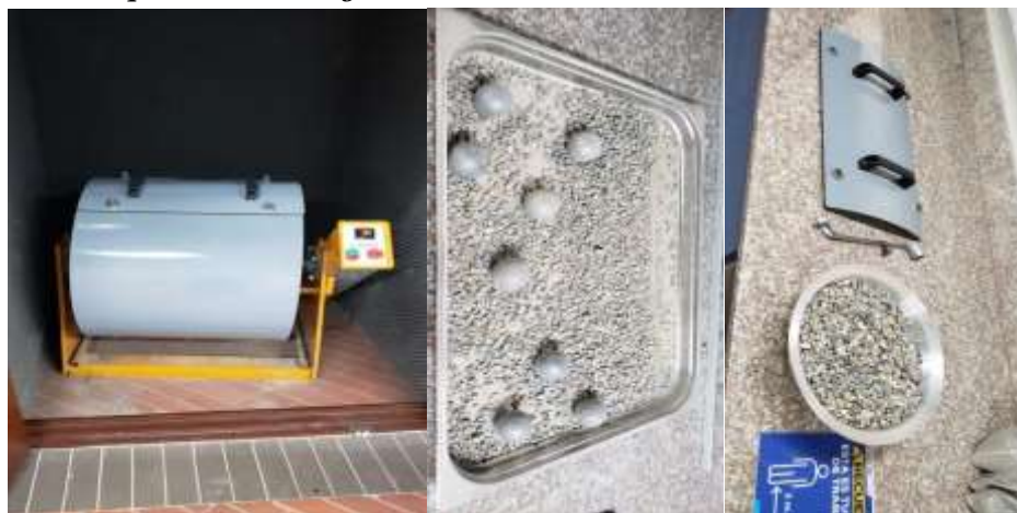
Figura 5. Desgaste Máquina de los Ángeles
