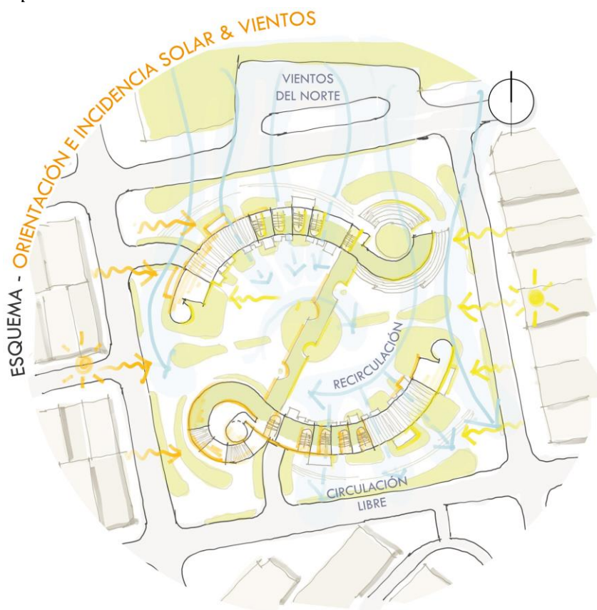
Figura 48. Esquema básico de ventilaciones.
