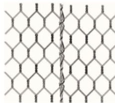
Ilustración 7 Detalle de las costuras o amarres
