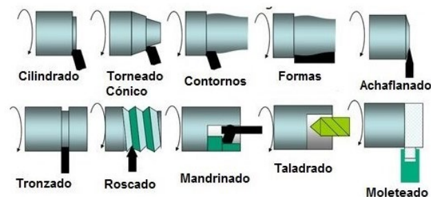
Figura 13: Procesos de mecanizado de un trono paralelo
