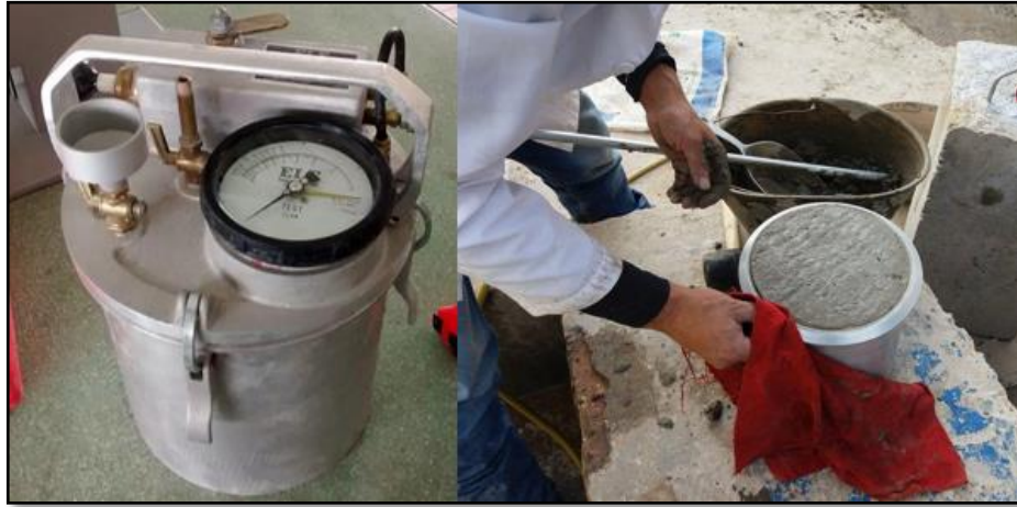
Fotografía 11. Prueba de aire confinado en la mezcla de concreto .
