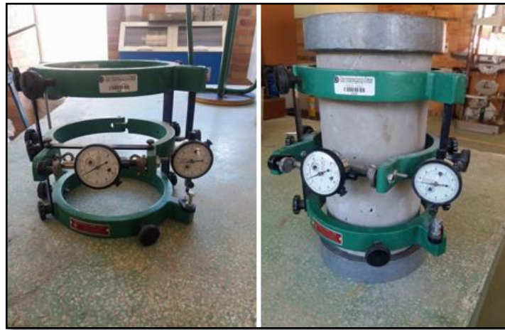
Fotografía 15. Anillos prueba módulo de elasticidad y relación de Poisson.
