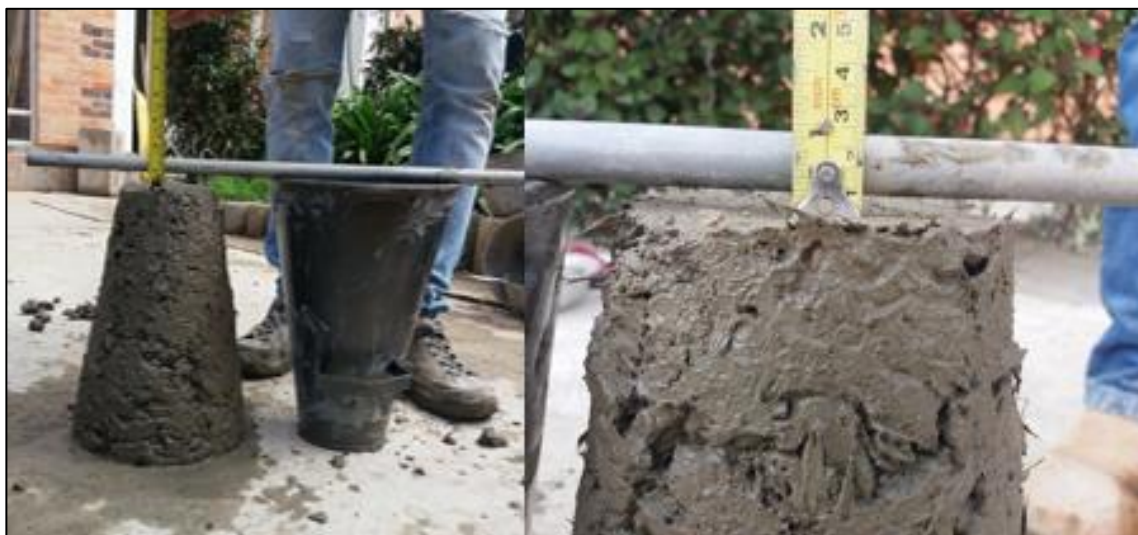
ANEXO: 6 Prueba de asentamiento fibra de vidrio AR
