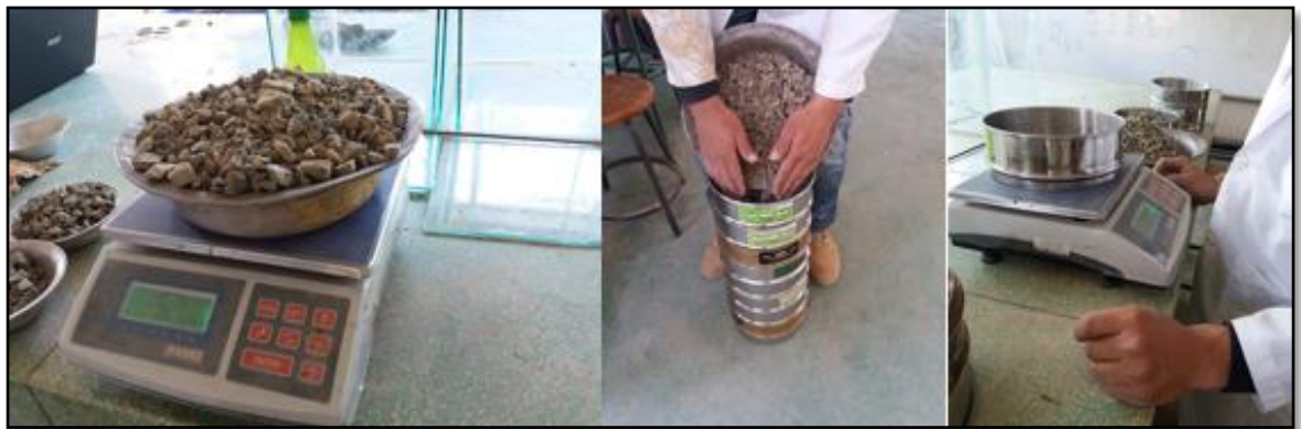
Fotografía 1. Tamizado de agregado grueso \frac{3}{4} ".
