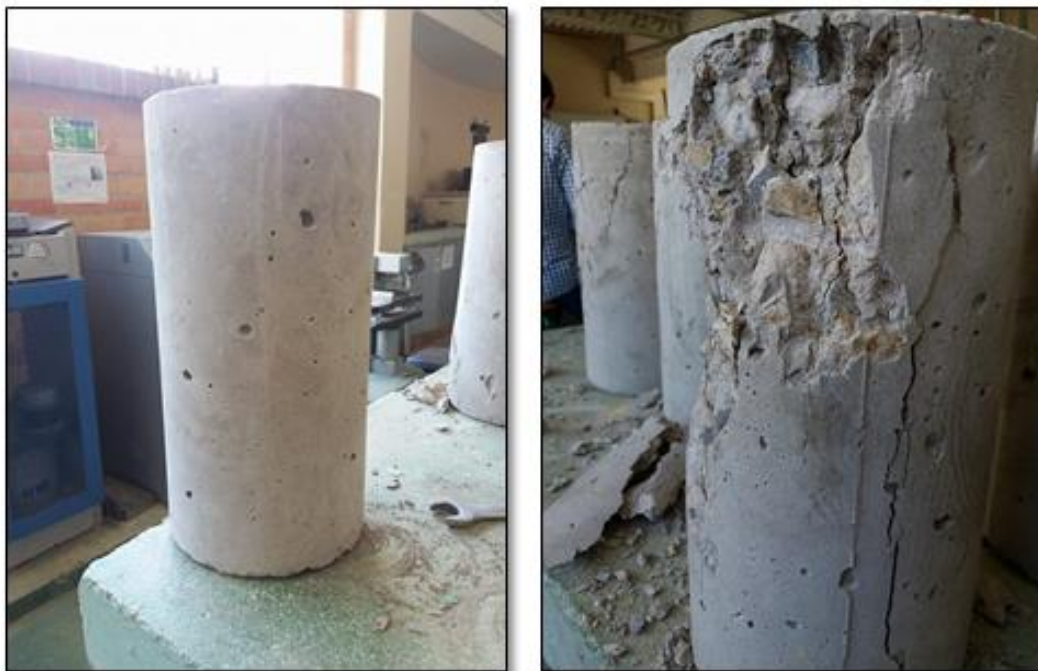
ANEXO: 19 Cilindro de concreto sin fibras “falla frágil” (antes y después de falla).
