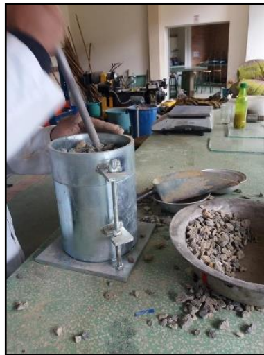
Fotografía 3. Determinación de pesos volumétricos seco compactado.
