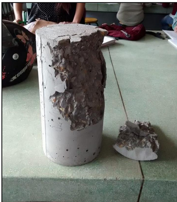
ANEXO: 20 Espécimen de concreto sin fibras (falla frágil)
