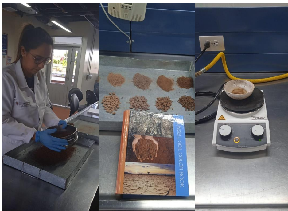
Figura 11. Preparación de muestras para ensayo densidad
