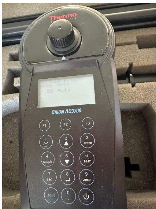
Figura 3. Color del agua de consumo humano un valor paramétrico máximo de 15 mg/l Pt/Co (platino -cobalto)
