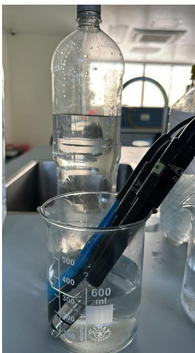
Figura 4. Toma de pH en muestra de agua de la IE
