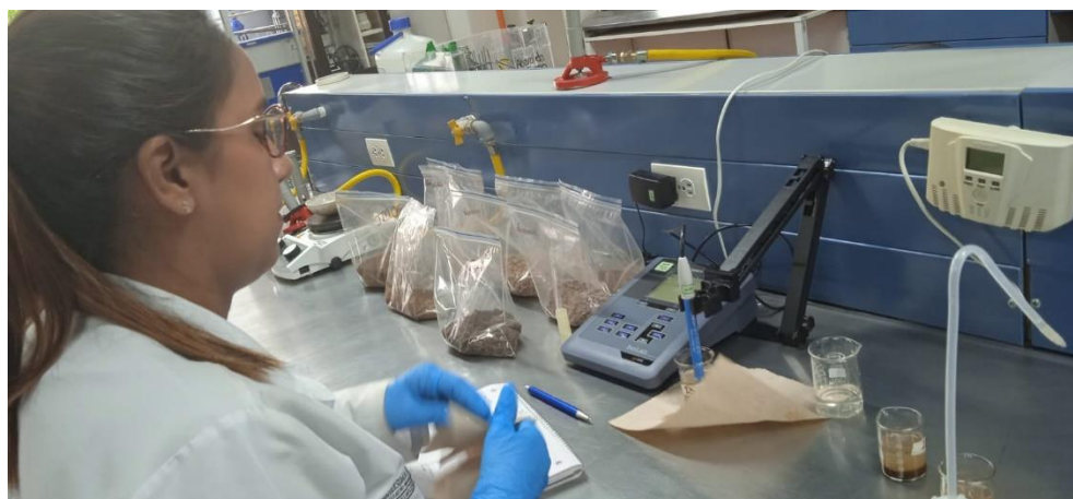
Figura 10. Determinación de PH del Suelo
