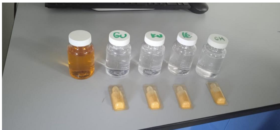
Figura 7. Preparación de muestras reactivo Coliformes
