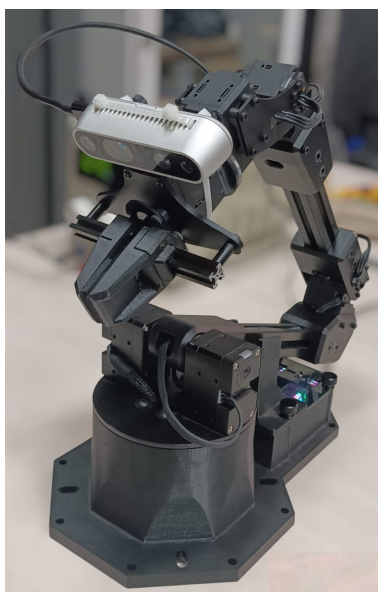
FIGURA 6: Montaje de cámara Realsense sobre brazo
