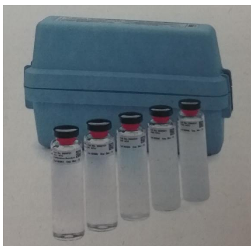
Figura 6. Celdas de calibración para Turbidímetro
