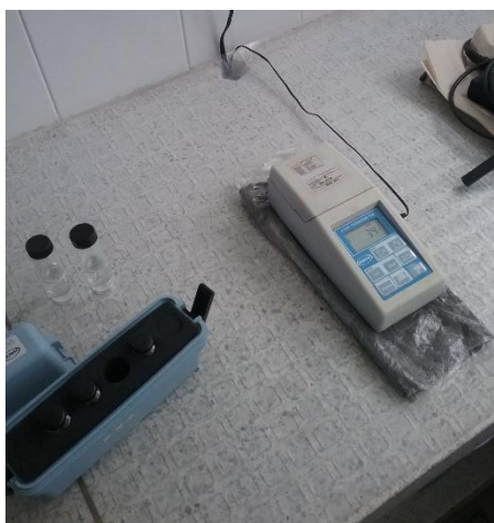
Figura 40. Calibración Equipo Turbidímetro 2100P (Planta).
