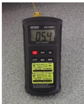
Figura 61. Termocupla electrónica realizando medición.
