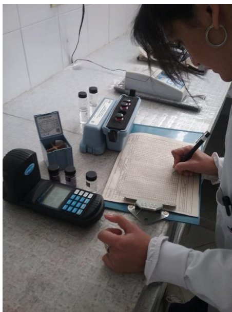
Figura 32. Calibración del Fotómetro DR890 (Planta).
