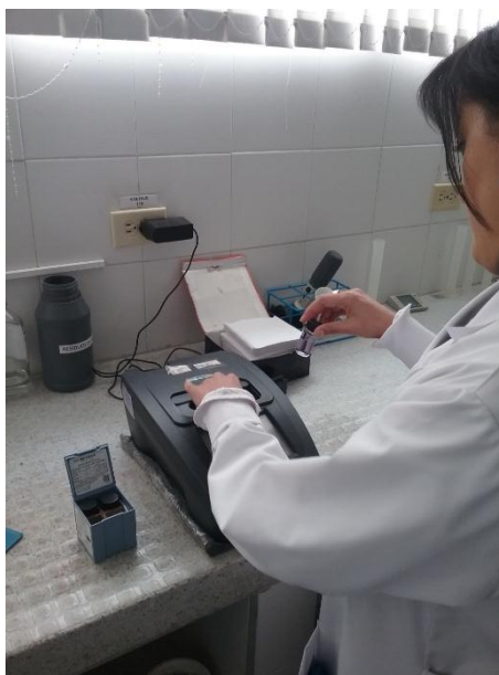
Figura 31: Calibración de Espectrofotómetro DR2800 (Planta).
