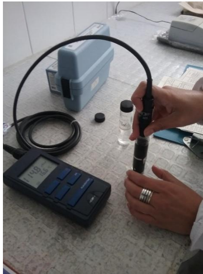
Figura 46. Calibración equipo Conductivímetro.
