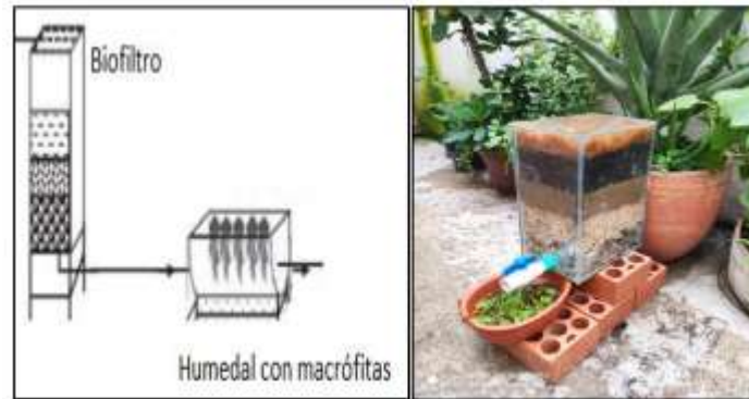
Figura 9 Sistema de Biofiltración con fibra de coco
