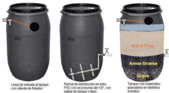
Figura 5 Sistema de filtración con filtro de arena.
