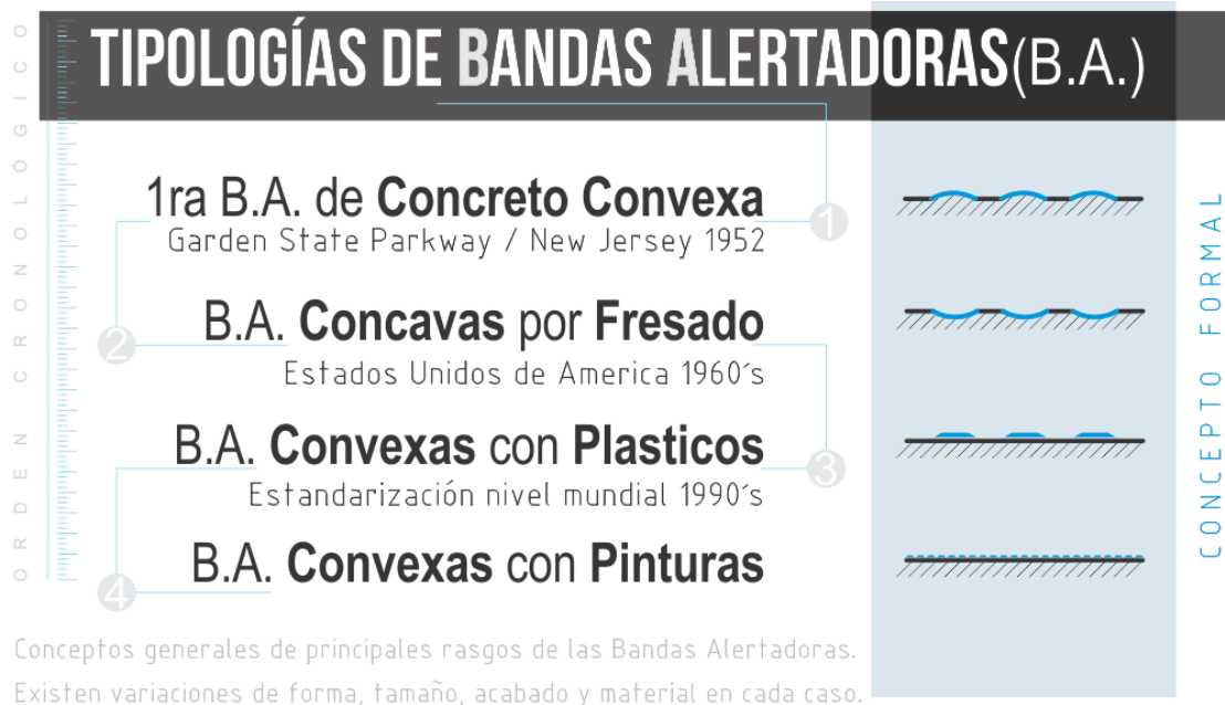
ILUSTRACIÓN 5. TIPOLOGÍA DE BANDAS ALERTADORAS. FUENTE: PROPIA.
