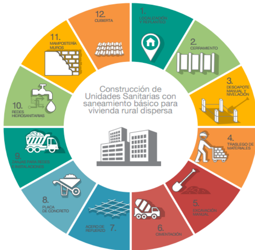
Figura 14 Proceso constructivo unidad sanitaria
