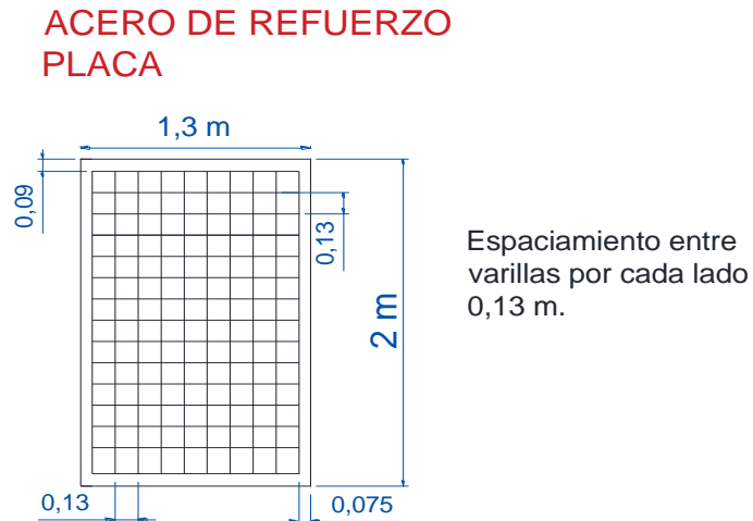
Ilustración 28: Despiece acero de refuerzo placa para malacate
