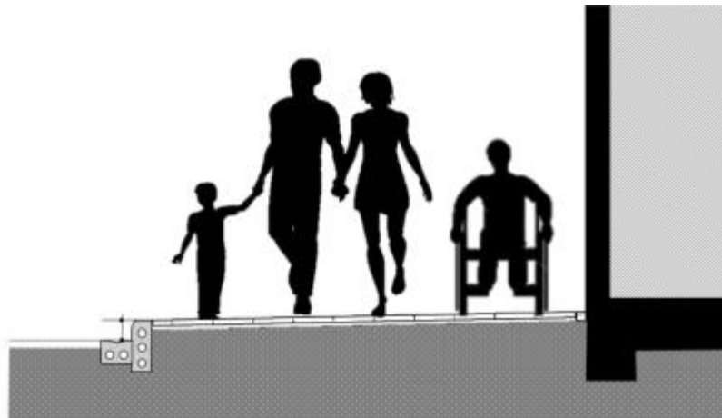
Figura 47. Pendiente transversal de anden tipo.
