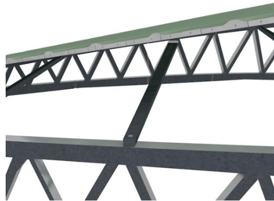
Correas sobre cercha para sostener la cubierta de teja termoacustica.
