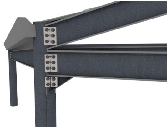
Correas sobre cercha para sostener la cubierta de teja termoacustica.
