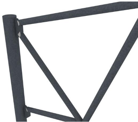
Anclaje a columnas de cercha para cubierta
