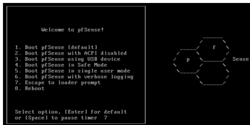
Ilustración 36: Opciones de instalación PFSense - Fuente: Autor
