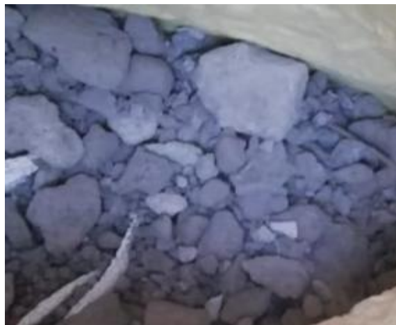
Figura 2: Pedrusco voluminoso, impurezas y agregado grueso
