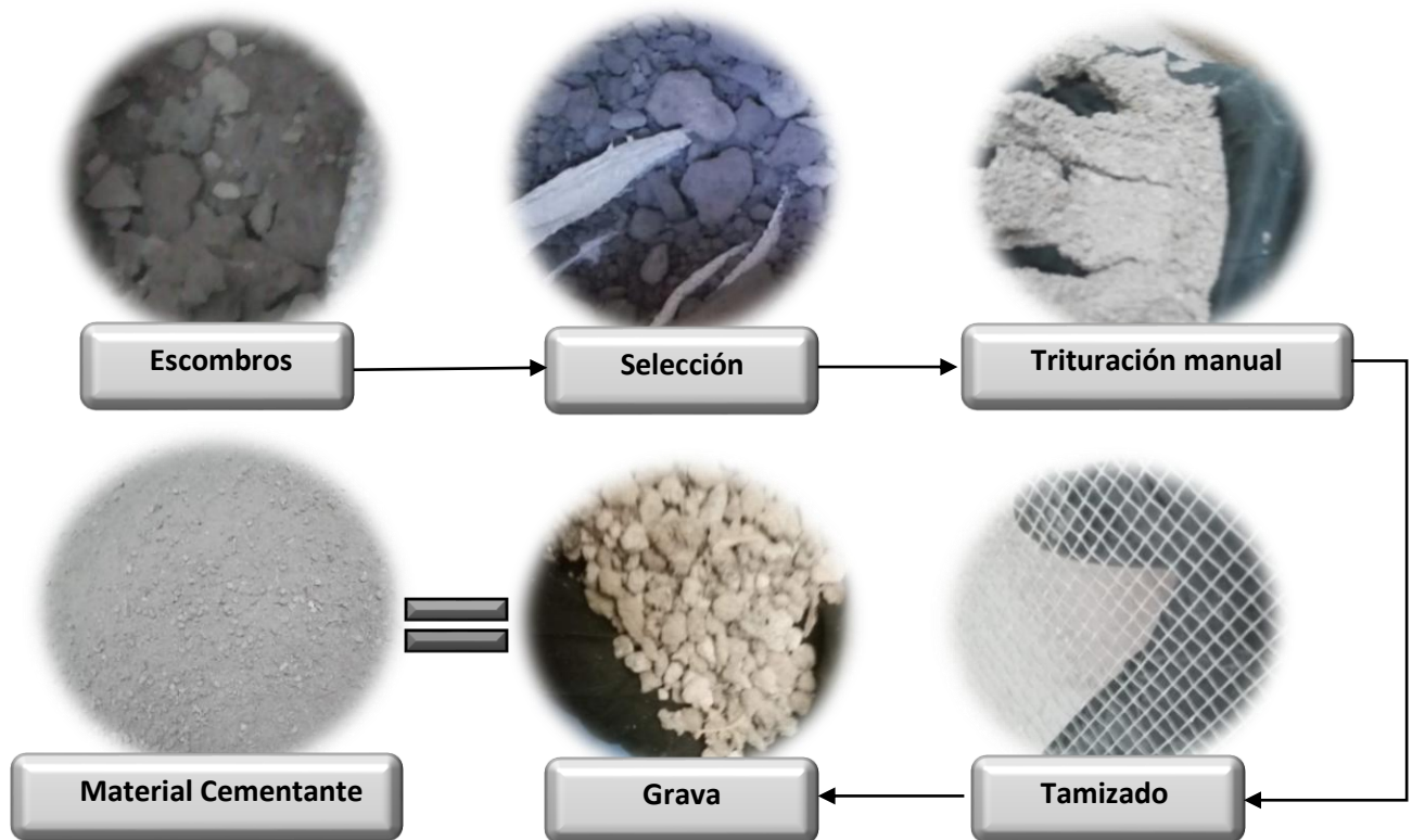
Figura 3: Proceso de obtención del módulo de finura
