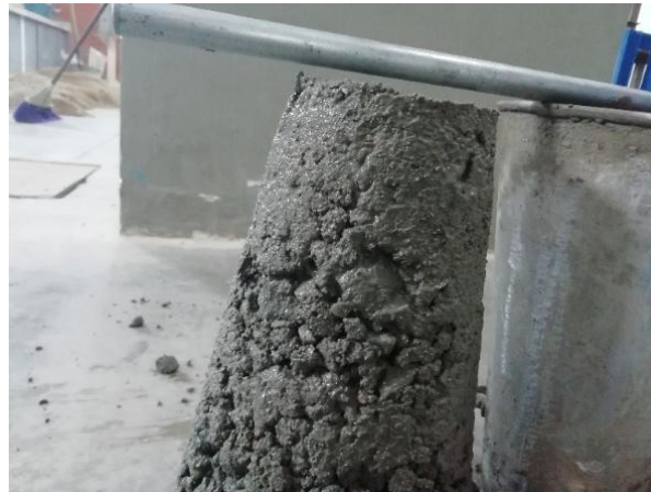
Figura 4: Prueba de asentamiento
