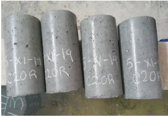
Figura 9A: Retiro de la zona de curado
