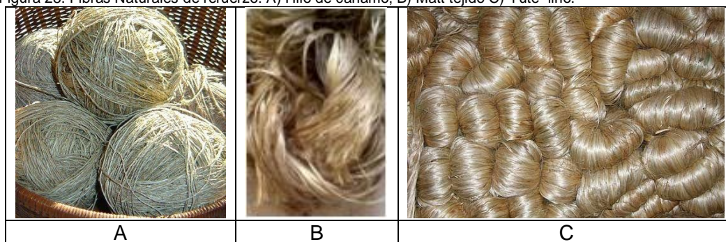
Figura 28. Fibras Naturales de refuerzo: A) Hilo de cañamo, B) Matt tejido C) Yute-lino.
