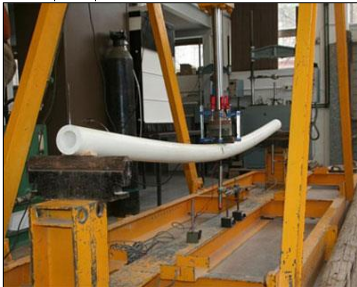
Figura 26. Prueba mecánica sobre perfil de pultrusión.
