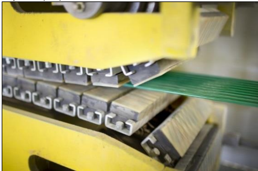
Figura 23. Método de jalado del perfil pultruidos
