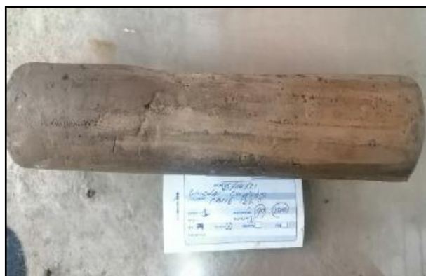
Ilustración 5. Resultado de estudio de perforación de suelos en el tercio alto del humedal
