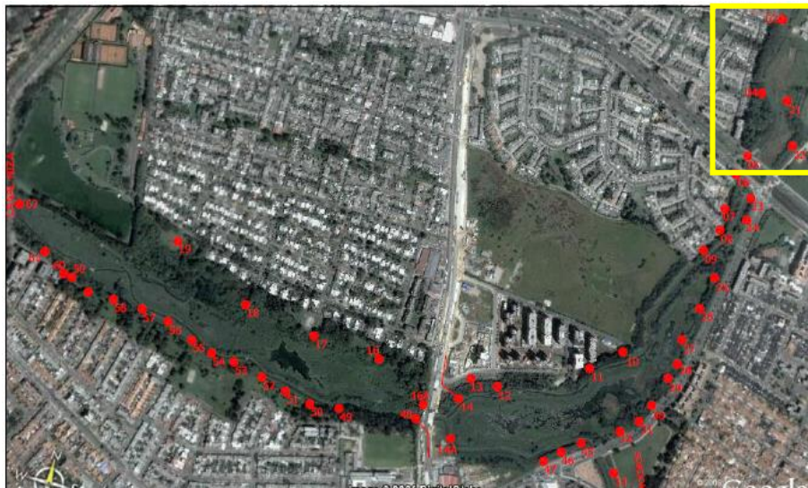
Ilustración 9. Colectores que drenan directamente al humedal Córdoba
