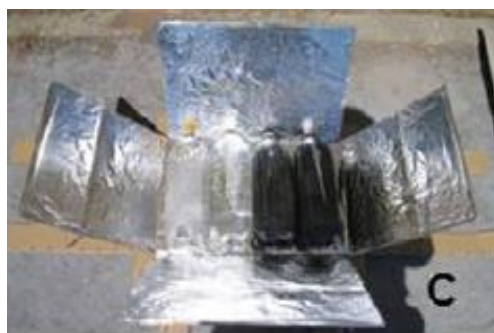
Imagen1: Concentrador solar y botellas PET
