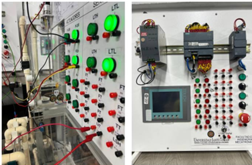
Figura 68. Tablero de conexiones del PLC y la planta piloto.
