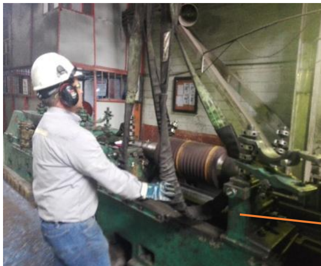
Figura 9. Montaje del cilindro al torno
