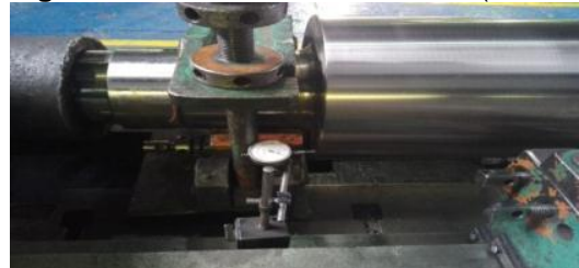
Figura 42. Verificación alabeo axial (0.04mm)
