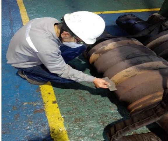
Figura 18. Verificación de las canales a rectificar
