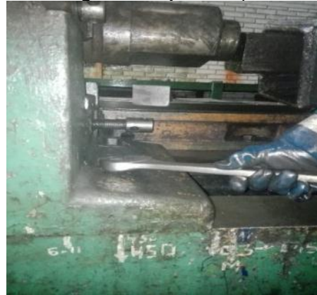
Figura 37. Ajuste de pernos de luneta
