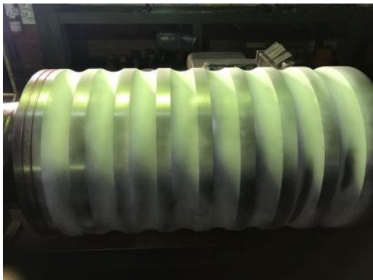
Figura 46. Inspección de cilindro con tintas penetrantes
