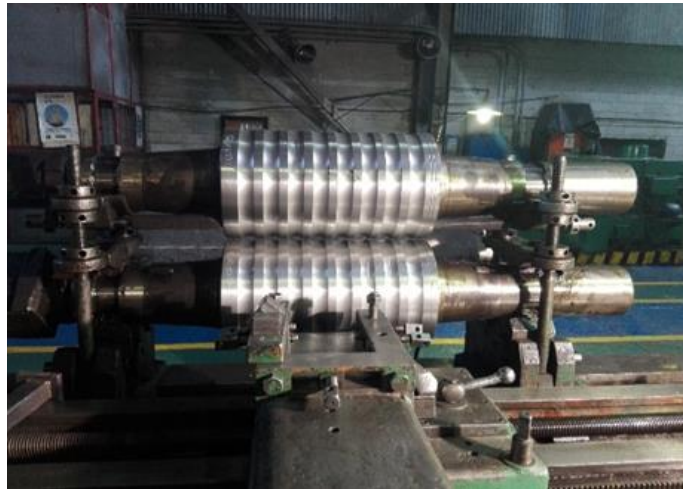
Figura 21. Montaje de los cilindros para alineación de canales.
