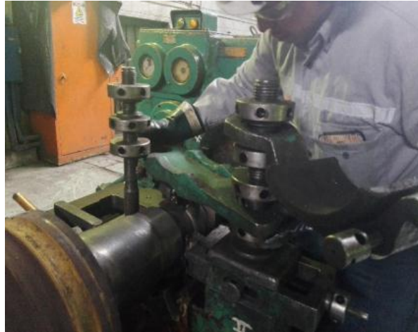
Figura 10. Ajustes entre chumaceras y cojinetes
