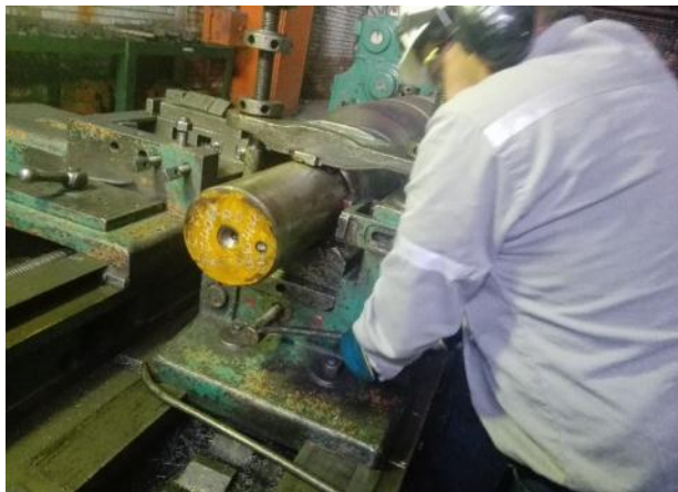
Figura 40. Ajuste lateral de los cojinetes
