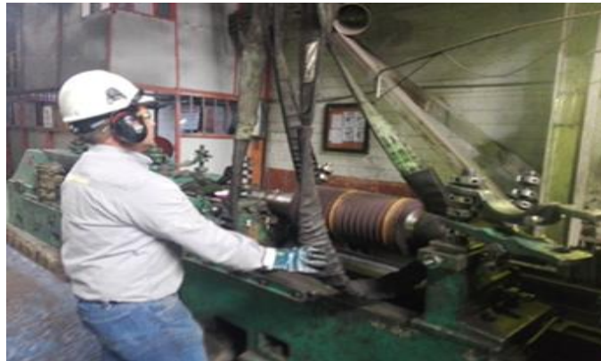
Figura 38. Montaje del cilindro en las lunetas
