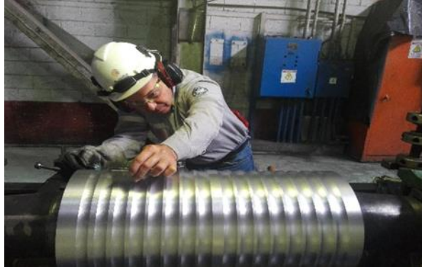
Figura 44. Supervisar canales terminadas
