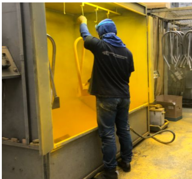
Ilustración 2 Cabina de pintura
