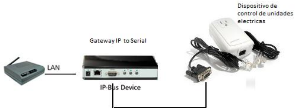
Figura 8. Control de Dispositivos eléctricos. Fuente: Autor.
