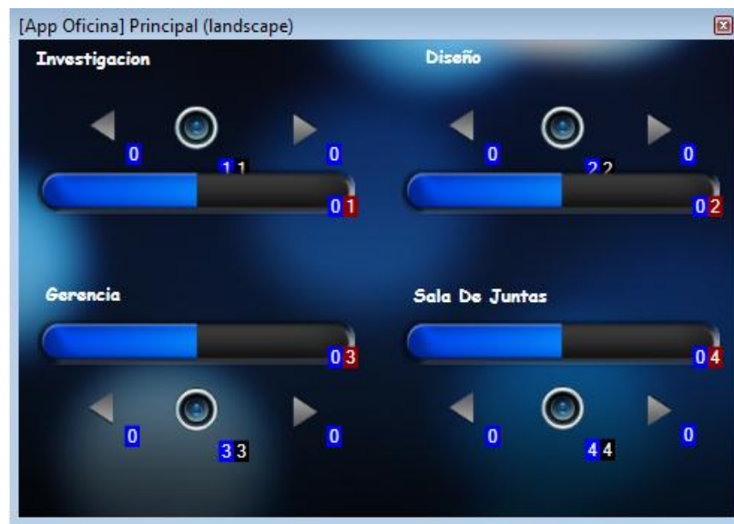
Figura 12. Aplicación de control de luces de la oficina. Fuente: Autor.
