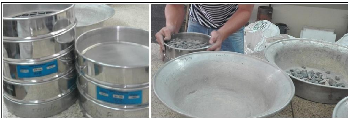
Figura 5. Materiales y procedimiento realizado en el ensayo de granulometría (NTC 77)
