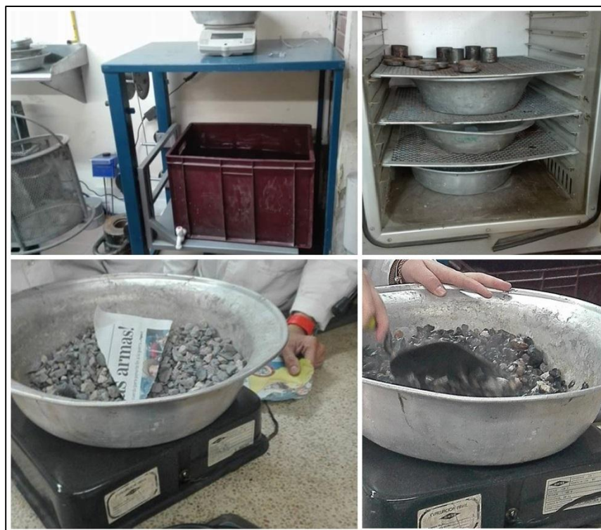
Figura 4. Materiales y procedimiento realizado en el ensayo de densidad de agregados gruesos (NTC 176)
