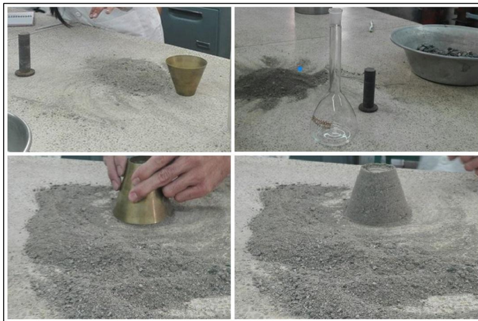
Figura 3. Materiales y procedimiento realizado en el ensayo de densidad de agregados finos (NTC 237)
