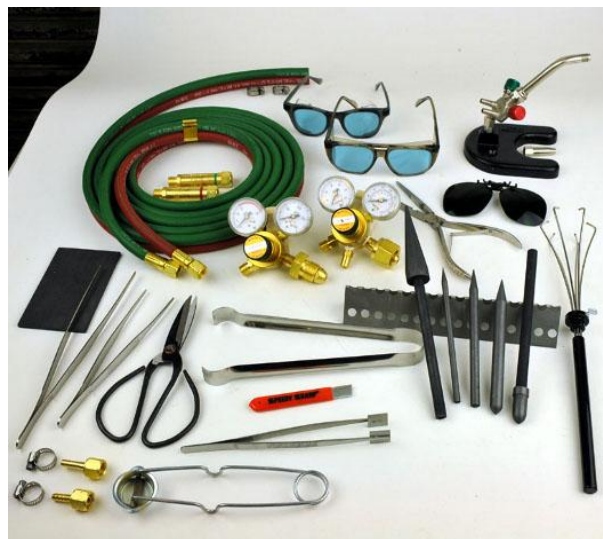
Figura 13: Herramientas para el trabajo en vidrio con soplete.
