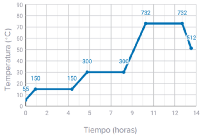
Figura 17. Curva de fundición de la resina Wax 40. Proporcionada por el fabricante [18]
