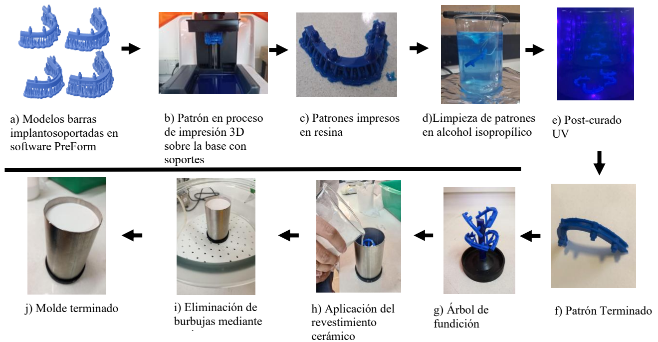
Figura 16. Metodología utilizada para la creación del molde de fundición, desde la impresión del patrón hasta la preparación final del molde. Fuente: Autores.
