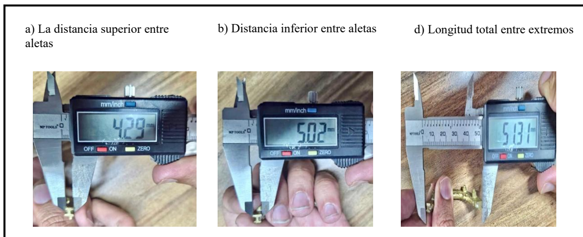
Figura 25. Medición directa sobre el modelo físico barra Tipo 3 (geometría en I), mediante calibrador de carátula. Fuente: Autores.
