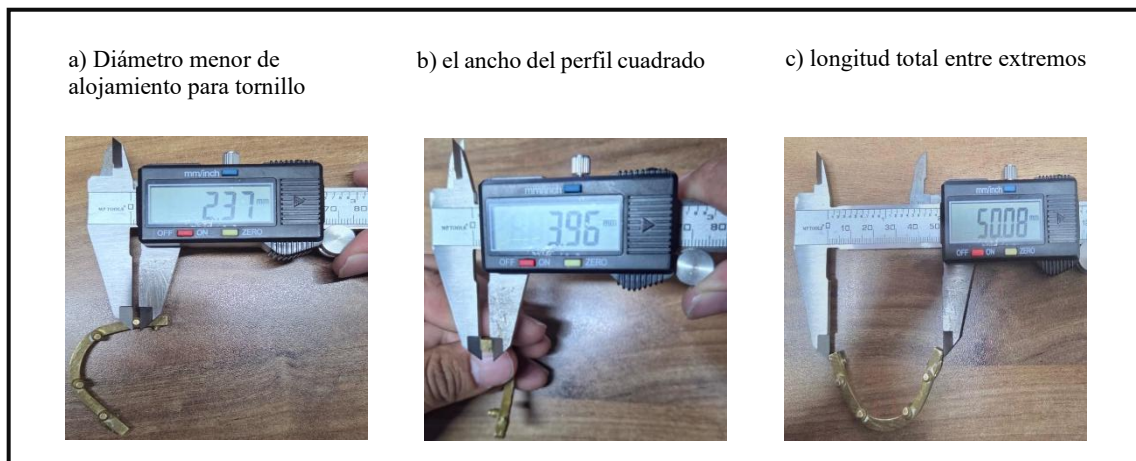
Figura 21. Medición directa sobre el modelo físico barra tipo 1 (geometría cuadrada), mediante calibrador de carátula. Fuente: Autores.
