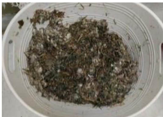
Ilustración 11. Mezclado de residuo de guadañado con el aglutinante
