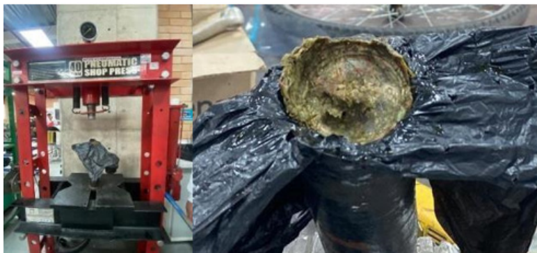
Ilustración 17. Prensa hidroneumática y desmolde
