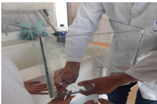
Ilustración 32. Pruebas de Fugas
