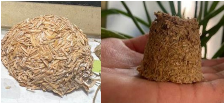
Ilustración 16. Resultado del molde con tamaño de partícula original y triturada
