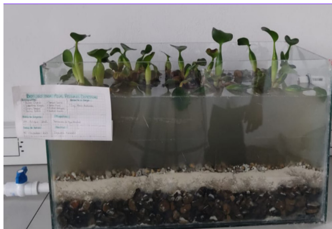
Ilustración 34. Biofiltro en etapa de pruebas
