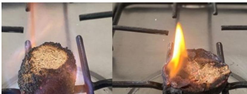
Ilustración 19. Color e intensidad de la llama para los dos tipos de briquetas
