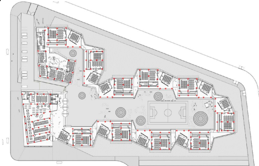
Figura 26. Ubicación de columnas en sistema estructural
