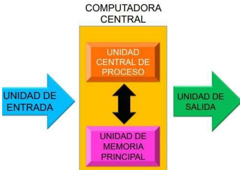
Figura 1. Esquema básico de hardware de un ordenador
