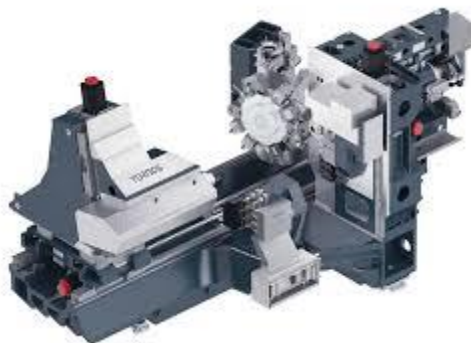
Figura 13 torno SWHISS DECO
