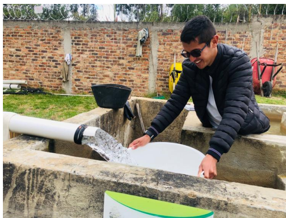
Fotografía 20. Toma de aforos volumétricos. Municipio de Firavitoba
