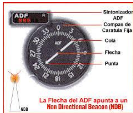
Figura 10. Funcionamiento de un ADF
