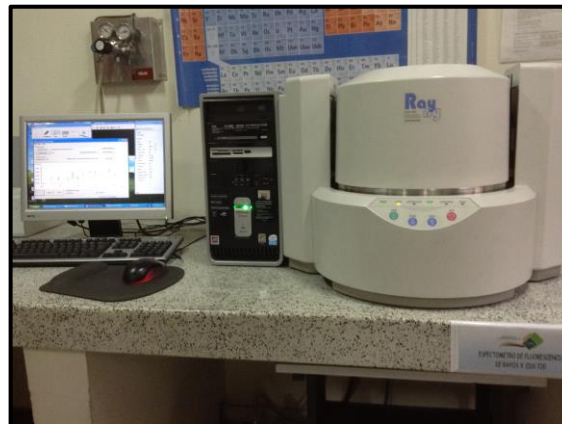
Fotografía 1. Espectrómetro de fluorescencia de rayos x Shimadzu EDX-720 de la Universidad Autónoma.
