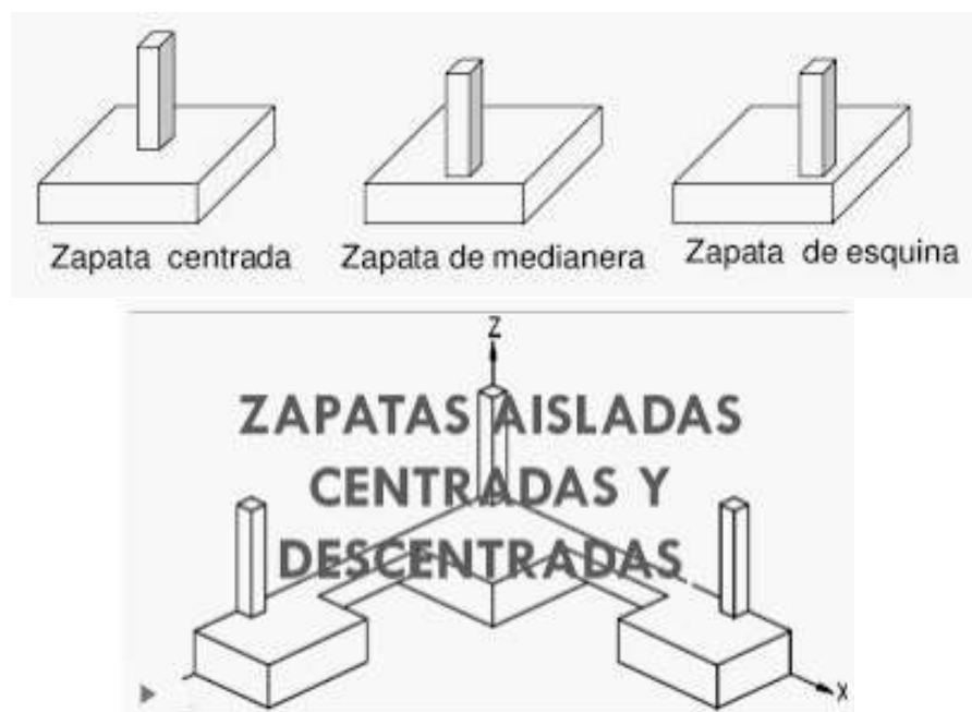
Figuras 22. Tipos de Zapatas. Fuente: elaboración propia
